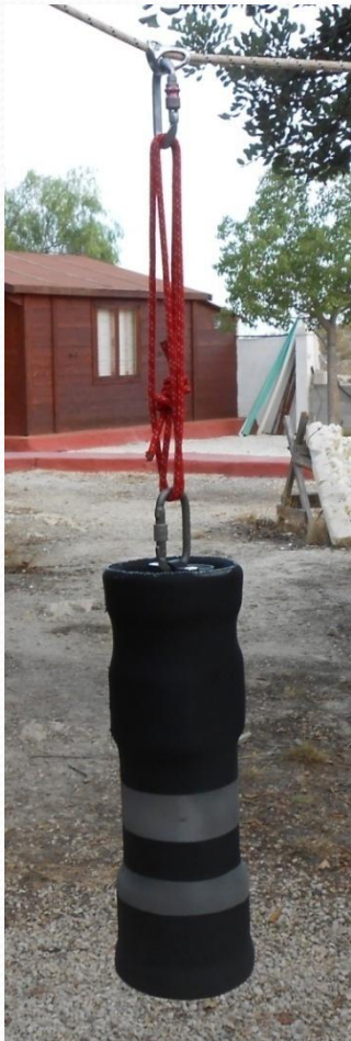
Sustentación a una cuerda con bloqueador
