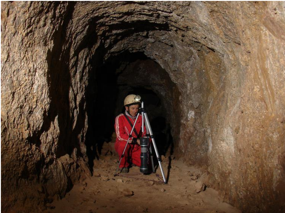
Foto 4. Equipo Microsummer listo para emitir, sustentado por trípode para su auto nivelación.
