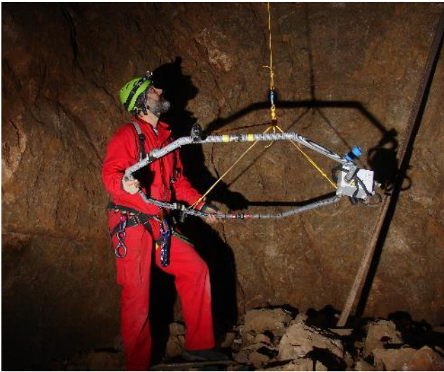
Fotos 5-6. Descenso de la baliza emisora Karma 2 por el pozo minero
